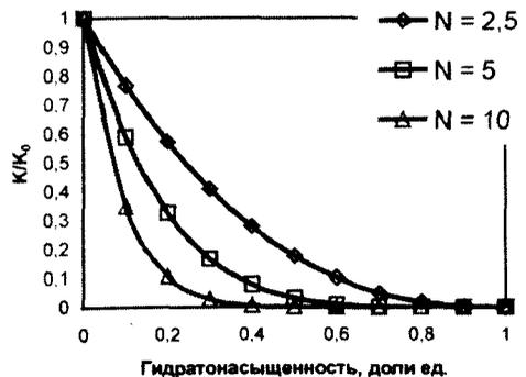
Рис. 4.4. Зависимость абсолютной проницаемости породы от гидратонасыщенности согласно формуле (4.5)
