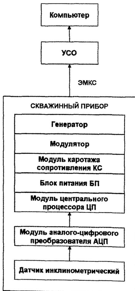
Рис. 1.10. Структура забойной телеметрической системы ЗТС-172 М
