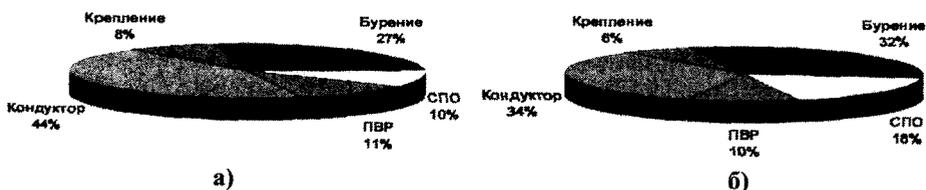
Рис. 2.13. Баланс календарного времени строительства скважин по: а) скоростной и б) базовой технологиям
