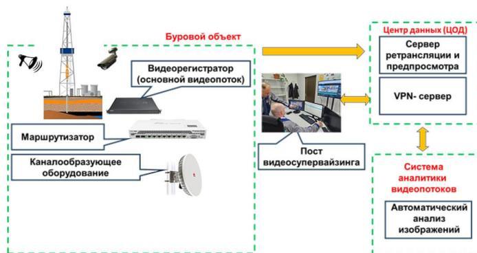
Рис. 1. Видеопотоки информации видеосупервайзинга
